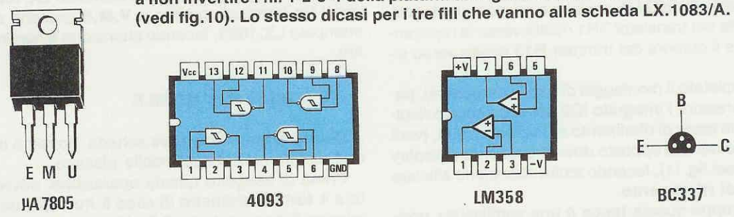
Fig.9 Connessioni degli integrati CD.4093 e LM.358 visti da sopra, del transistor BC.337 visto da sotto e dell'integrato stabilizzatore uA.7805 visto frontalmente.
